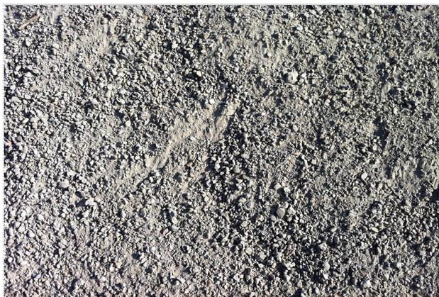
Ilustración 5. Árido reciclado de hormigón.
